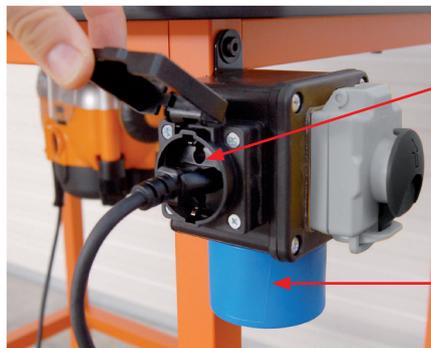
Presca di connessione dell'elettrofresatrice
