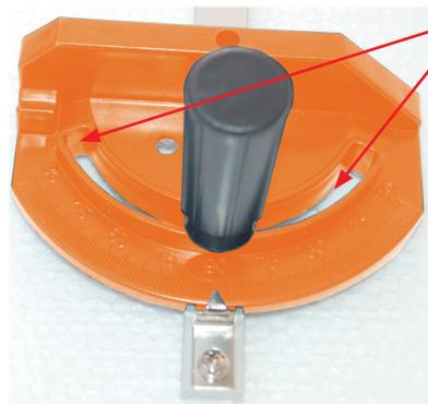
2 Provvedere alla regolazione del goniometro in funzione delle necessità produttive: la regolazione può variare da 60° in senso orario a 60° in senso antiorario
