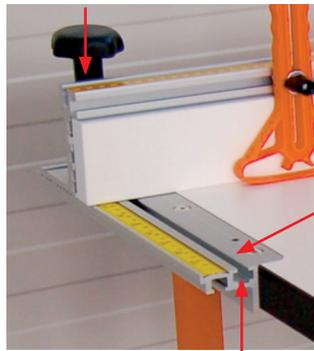
2 Fare scorrere l'intero blocco guida, egualmente da entrambi i lati. Per facilitare l'allineamento, sfruttare le due apposite righe metriche ai lati del piano di lavoro.
